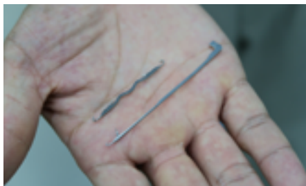
編み機にセットされている小さなかぎ針のパーツ。 Knitting machines are set with tiny crochet needles.
