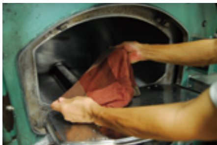
仕上げは洗いをかけて、ふっくらとした風合いに。 The fabric is given a finishing wash to fluff it out for a softer texture.
