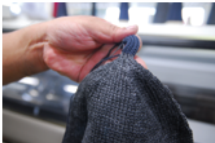
テンションを保ちながら編むために必要となる捨て糸部分。 Scrap yarn is used to maintain tension during the knitting process.
