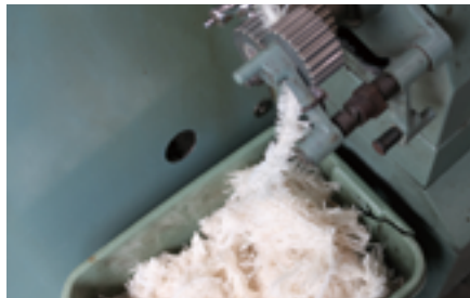
生地の耳はリサイクルされ、新たな素材に生まれ変わる。 Recycling scrap fibres to transform them into new materials.
