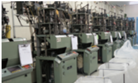
整然と並ぶ靴下専用の丸編機。 A long neat row line of circular sock-knitting machines.
