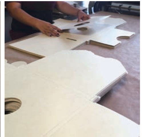
中身の劣化につながるため接着剤は使用せず、金具のみで組み立てます。 To avoid the deterioration of the contents, the boxes are constructed with metal fittings and no adhesives.
