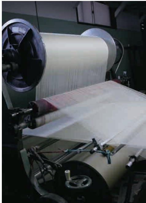
パイル（繊維）用とグラウンド（基布）用に分けてセットされた経糸。 The pile and ground warp are set separately.
