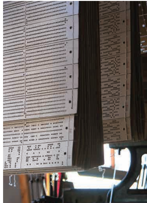
紋紙。織り方の情報すべてが詰まっている。 Every last snippet of information on weaving methods is recorded on large sheets of card.
