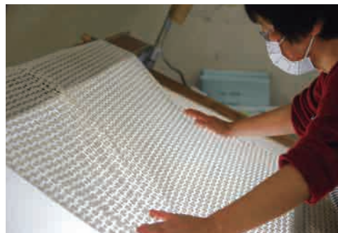
汚れや破損がないか、人の目でしっかりとチェック。 Workers do a visual check for smudges and rips.
