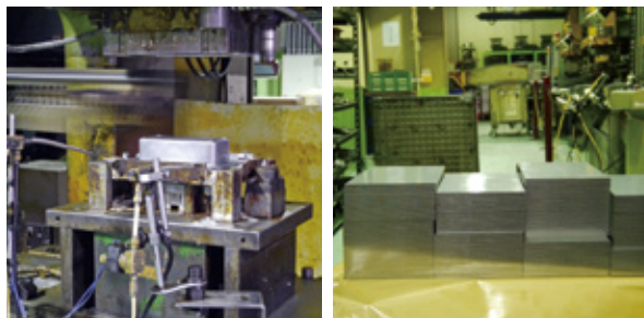
高い圧力をかけスチールの板をプレスする。丈夫な工具箱をつくる高度な技術。
